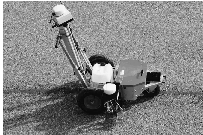
Mit dem neu angeschafften, GPS-gesteuerten Markiergerät können auf der Sportanlage Schiffacker die Sportfelder effizienter markiert werden. Das aufwendige Einmessen der Felder zu Saisonbeginn entfällt, ebenso wie die Markierungen zum Erhalt der Linien.
