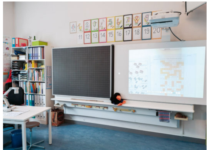
Interaktive Wandtafel aus Kurzdistanzbeamer und weisser Projektionsfläche
