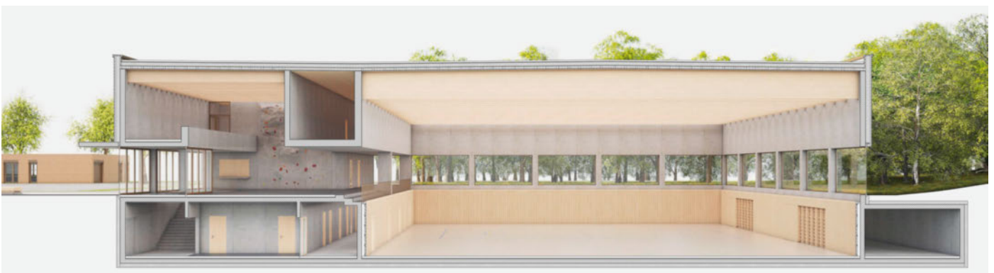
Schnittansicht quer durch das Gebäude
